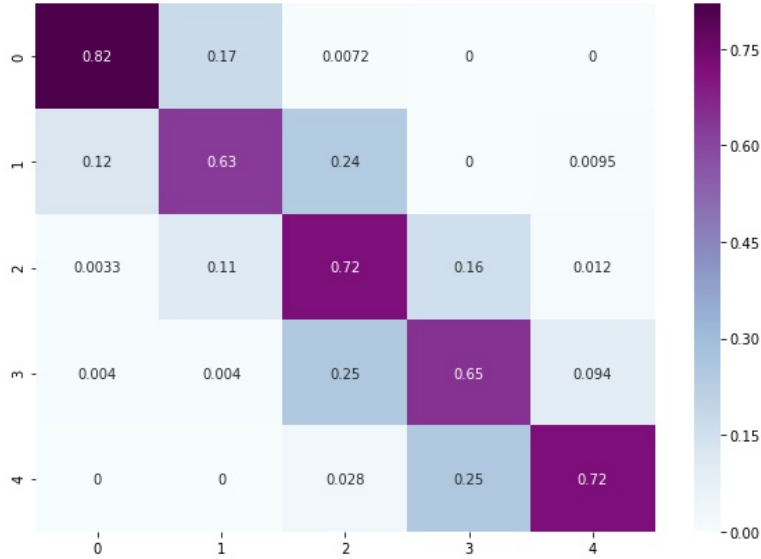
Figura 5.11: Matriz del modelo que usa ResNet50 monitoreado con un conjunto no balanceado.
