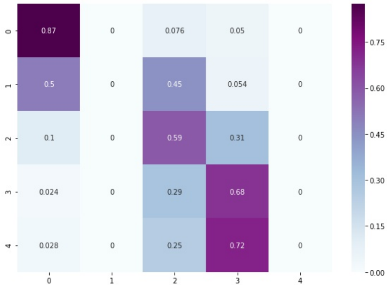
Figura 5.8: Matriz de confusión del modelo preentrenado con la tarea de RPL y usando transferencia de conocimiento.
