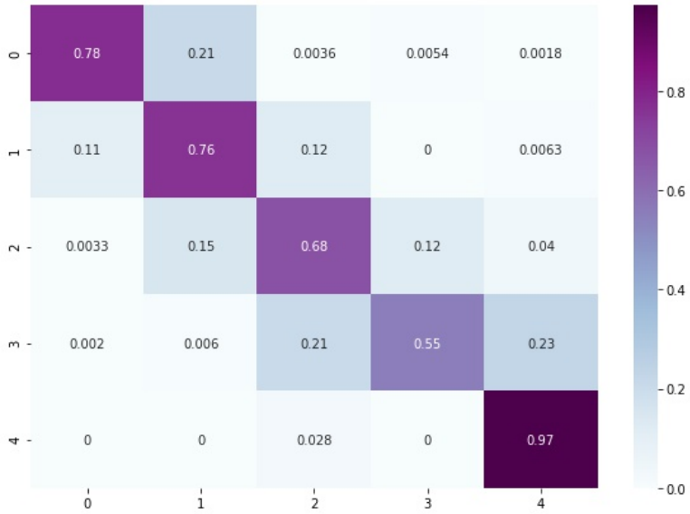
Figura 5.12: Matriz de confusión del modelo que usa ResNet50 monitoreado con un conjunto balanceado.
