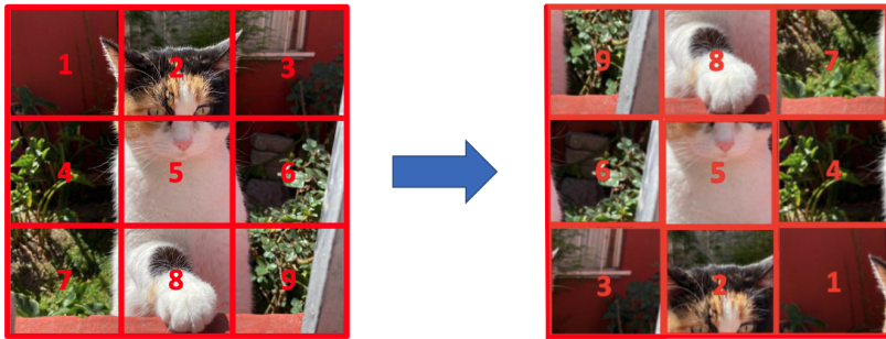
Figura 3.9: Autoetiquetado usando relative patch location para la tarea de pretexto.
