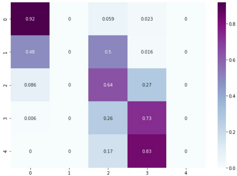
Figura 5.5: Matriz de confusión del modelo preentrenado con la tarea de jigsaw con 50 clases y usando fine tuning .
