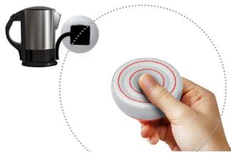
**9C.** Presionar la superficie táctil 3 segundos para apagar o encender los medidores en un radio de 1m. Una vibración corta indica encendido, dos vibraciones, apagado.
