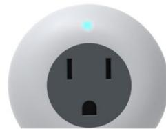
**4.** Conectar el medidor a la corriente eléctrica. Esperar a que el led incorporado deje de parpadear y permanezca encendido.
