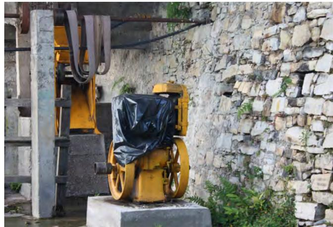
Fig.44 Fotografía de la máquina despulpadora
