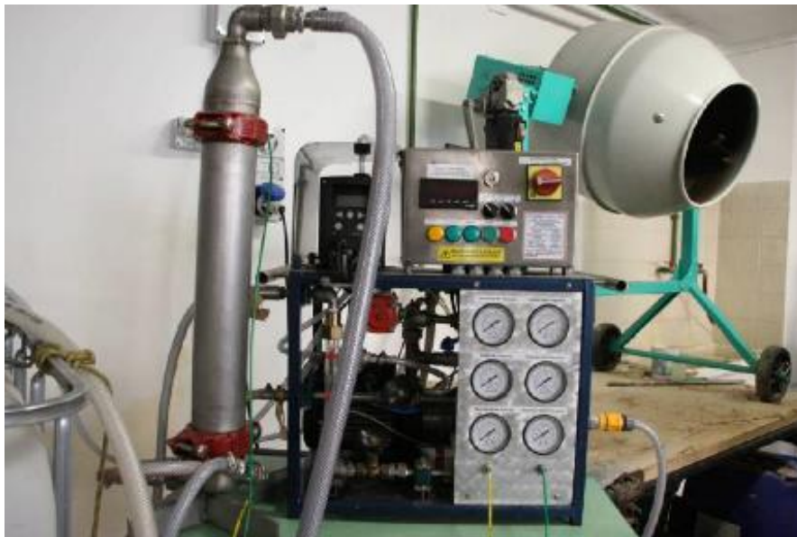
Figura 4.11 Generador de espumas empleado en el Politécnico de Turín y sus componentes. (Cortesía COMISSA)
