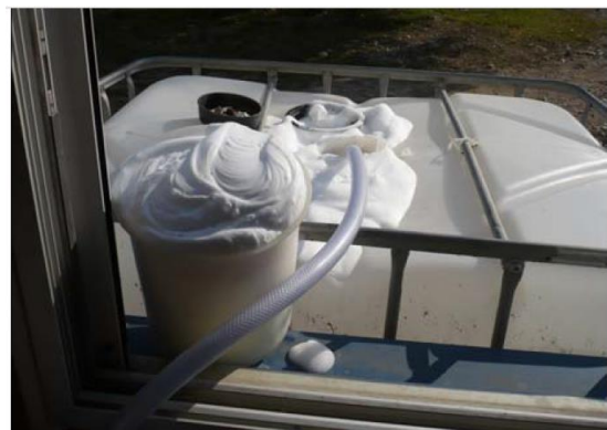
Figura 3.62 Espuma generada para su ensayo. (SÁNCHEZ, 2007)
