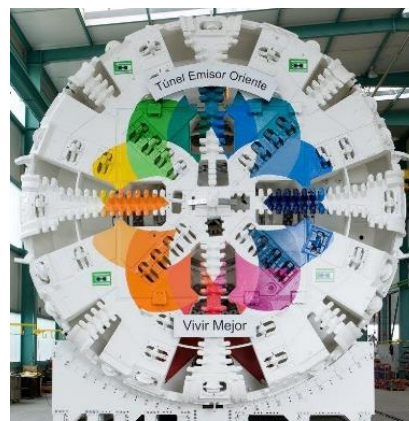
Figura 4.7 Rueda de corte de la EPB 519. (Cortesía de COMISSA)
