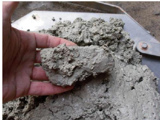
Figura 4.14 Ejemplo de grumos duros y cohesivos formados en la arcilla. (Cortesía de COMISSA)
