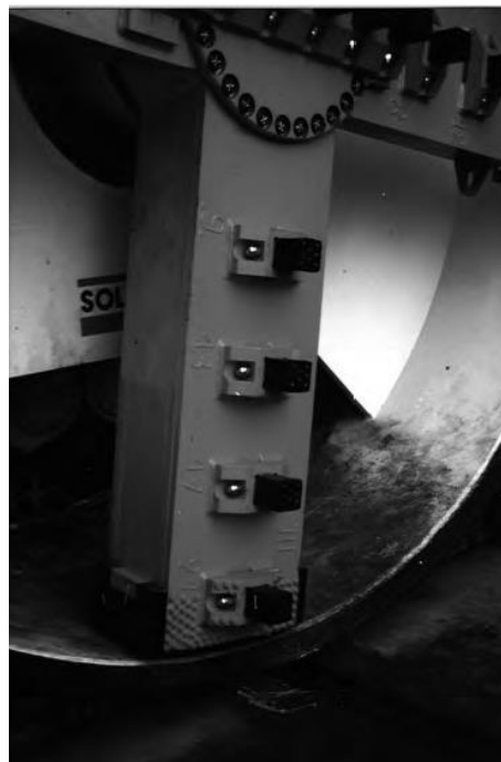
Figura 3.25 Picas de sección cuadrada (80 mm x 80 mm), S-100 Mixshield Bewag Tunnel, Berlín, 1995 (MAIDL ET AL., 2012)
