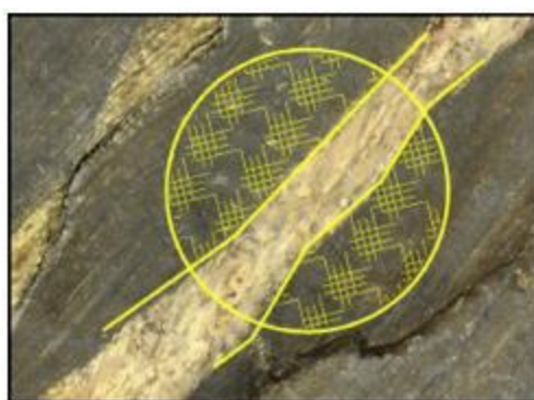
Figura 3.52 Terreno mixto de tipo capa de suelo en roca, (TÓTH ET AL. 2013, recuperada de PAT, 2019).
