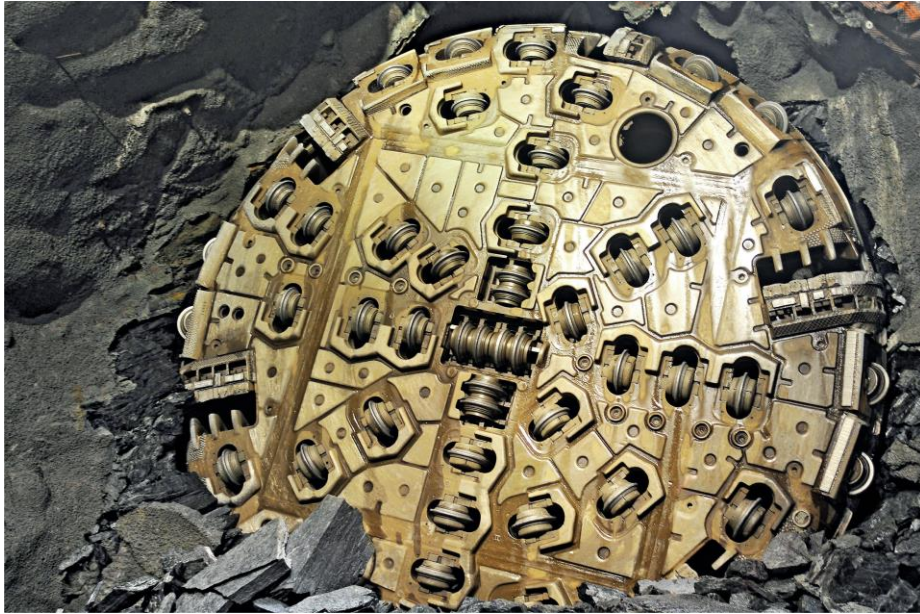
Figura 3.14 Se observa una rueda de corte de tuneladora para roca con los discos de corte en sus diferentes posiciones. (HERRENKNECHT, 2019)
