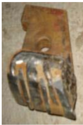
Figura 3.36 Pica desgastada por la abrasividad del suelo. (GONZÁLEZ, 2014)
