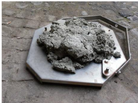
Figura 4.15 Suelo acondicionado con el polímero Mapedrill M3. (Cortesía de COMISSA)
