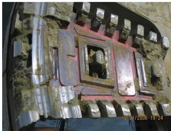
Figura 3.32 Detalle del desgaste en el borde de la cabeza de corte. (PÉREZ, 2009)
