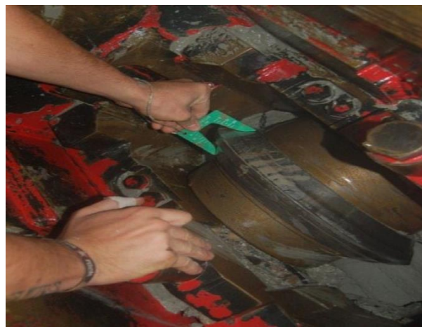
Figura 3.42 Medición de desgaste en un disco. (HERRENKNECHT, 2019)
