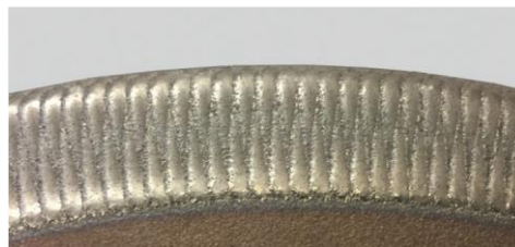
Figura 3.17 Ejemplo de cuchilla de acero con cara endurecida HF. (HERRENKNECHT, 2019)
