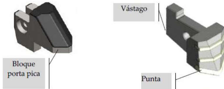
Figura 3.22 Partes de una pica (BARTZ, 2009. Recuperado de GONZÁLEZ, 2014)
