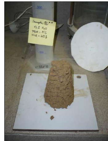
Figura 3.67 Ejemplo de una prueba slump test (SÁNCHEZ, 2007)
