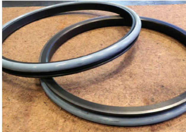
Figura 3.10 Sello durable de cara metal-metal para eliminar el ingreso de suciedad y evitar la pérdida de aceite del interior del disco. (ROBBINS, 2019).
