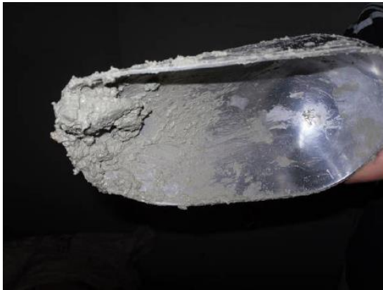
Figura 4.13 Se observa la pegajosidad de la arcilla en superficies metálicas. (Cortesía de COMISSA)
