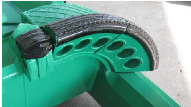
Figura 3.29 Detalle de un rastrel de última generación con plaquitas de carburo de tungsteno. (PÉREZ, 2009)
