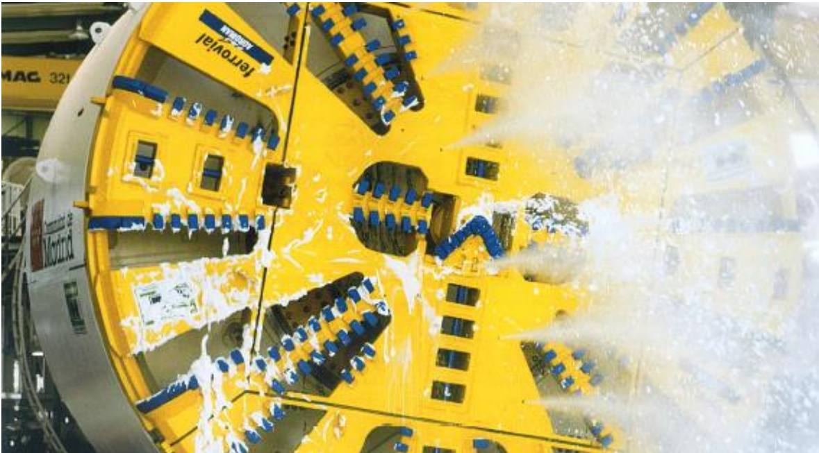
Figura 3.57 Acondicionamiento con espuma a través de la rueda de corte (MAIDL TUNNELCONSULTANTS, 2014)
