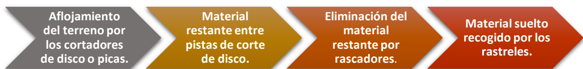
Figura 3.7 Mecanismo de corte del terreno. (HERRENKNECHT, 2018)
