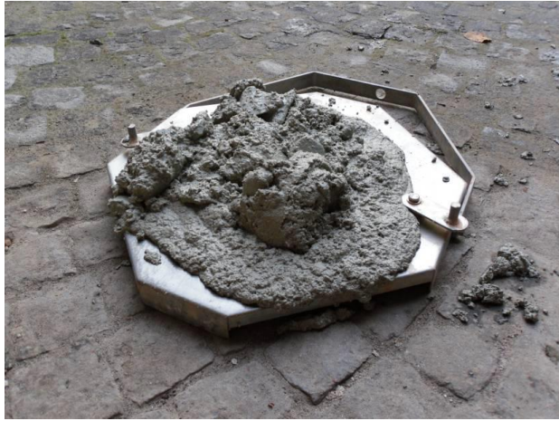
Figura 4.17 Muestra de suelo acondicionada con polímero Mapedrill M3 y la adición de Polyfoamer FL. (Cortesía COMISSA)
