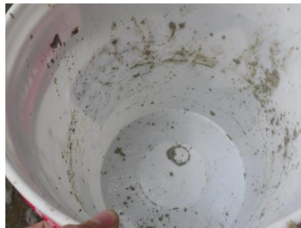
Figura 4.16 Imagen de la cubeta empleada para el mezclado del suelo y el polímero, se observa la superficie limpia, pegajosidad eliminada. (Cortesía de COMISSA)
