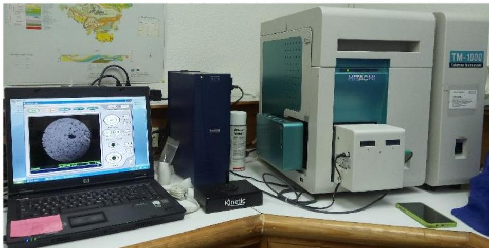
**Figura 4.3.** Fotografía del SEM de mesa Hitachi TM-1000 y el equipo de cómputo usado para operarlo en el Laboratorio de Petrografía y Microtermometría del IGEF de la UNAM.
