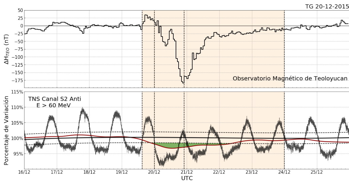
Figura 4.2. Se presentan los datos de la TG-1. A partir del \Delta H_{Teo} se obtuvo la ventana de tiempo que duró la perturbación geomagnética, la cuál presenta claramente las fases inicial, principal y de recuperación (líneas verticales punteadas). En la parte inferior, la tendencia de los datos obtenidos para canal S2_Anti del TNS muestra un decrecimiento Forbush durante la TG, el cual fue máximo durante la fase principal de la misma. El área verde representa -1 ATG.
