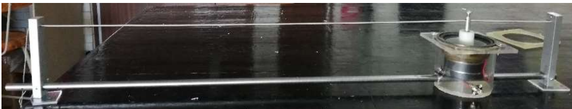
Figura 2.13. Sistema para la oscilación de una cuerda de bajo costo.
