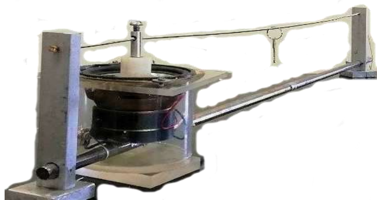
Figura 1.9. Sistema construido para el estudio y análisis de la oscilación de una cuerda.
