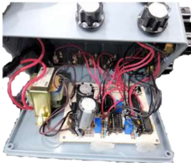
Figura A.3. Generador de funciones de cuatro canales instalado en caja.
