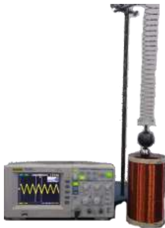
Figura 2.2. Sistema para el análisis del movimiento oscilatorio de un resorte.
