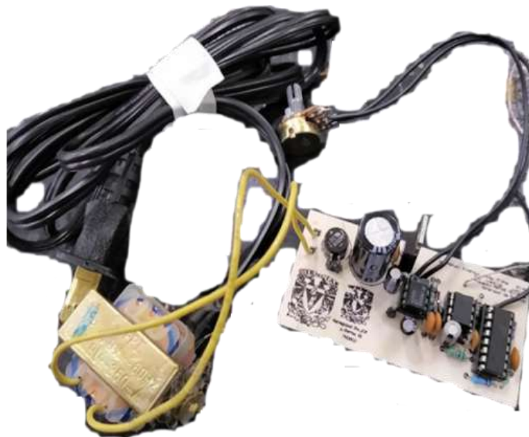
Figura A.9. Generador de barrido sin instalar.
