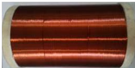
Figura 2.3. Bobina construida para registrar el movimiento del resorte.
