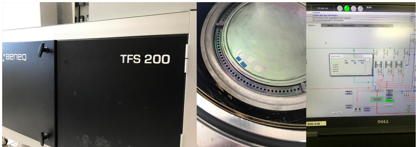
Imagen 42. Proceso de ALD con Beneq TFS 200, vista del interior del reactor con sustratos depositados y algoritmo de depósito [elaboración propia con la colaboración de UNaFab]
