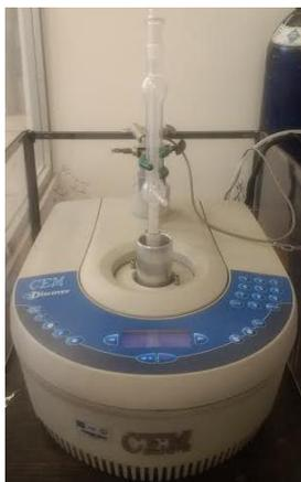
*Figura 4. Microondas de síntesis orgánica con refrigerante acoplado.*
