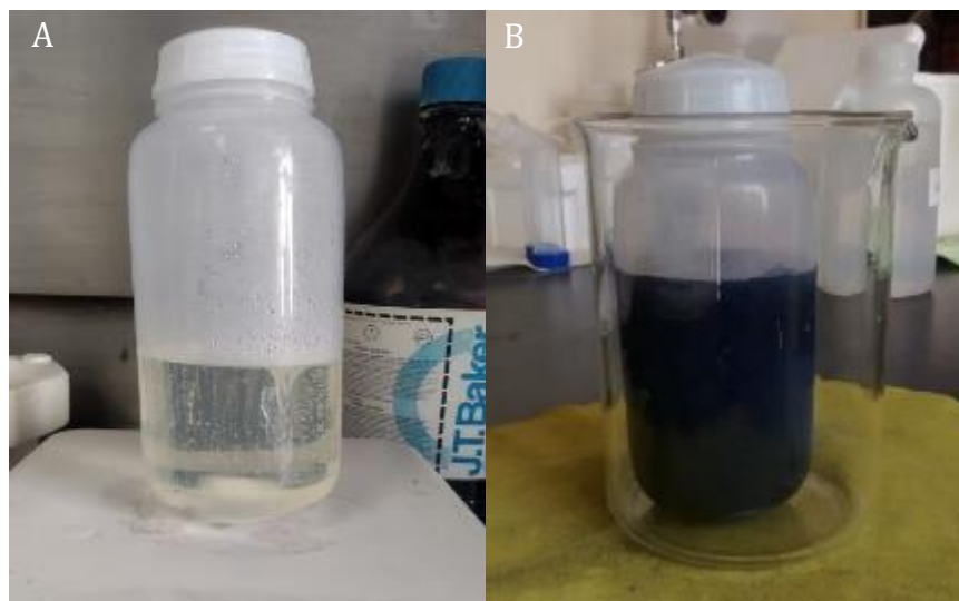
Figura 6.3 Sistemas A) COLTIO ( TiO_2 precursor) y B) GO- TiO_2 : óxido de grafeno dispersos en solución metanol/ H_2O previo al proceso solvotermal.
