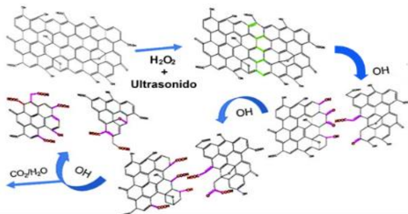
Figura 5.5. Mecanismo de corte oxidativo asistido por ultrasonido, los grupos epóxido ubicados en los planos basales del óxido de grafeno se muestran de color verde y los grupos carboxilos formados en los bordes a partir del ataque de radicales OH en el proceso de fragmentación de color morado. [Adaptada de: Jiawei, Materialstoday Communication , 2016]
