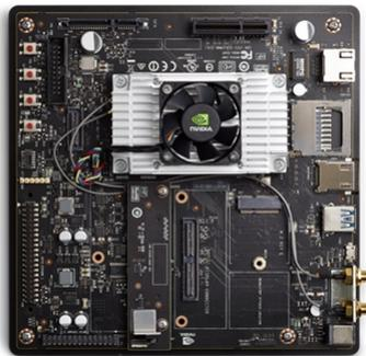
Figura 5.4: Unidad principal de procesamiento, Nvidia Jetson Tx2
