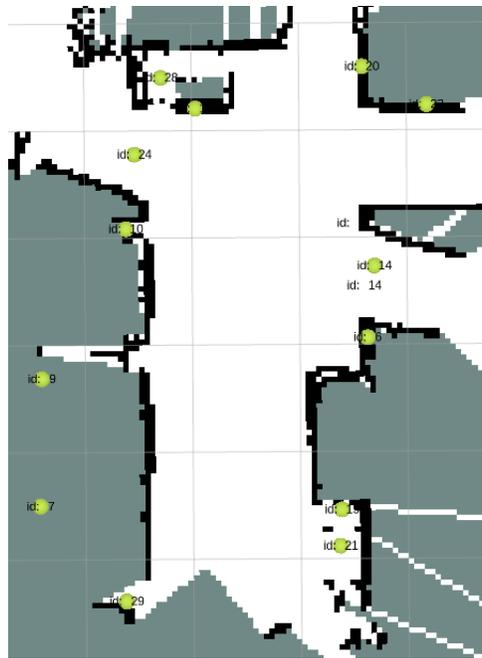
Figura 6.7: Posición de los códigos ArUco dispuestos en el entorno del robot
