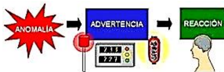
Figura 5.12 Ejemplo de un Andon.
