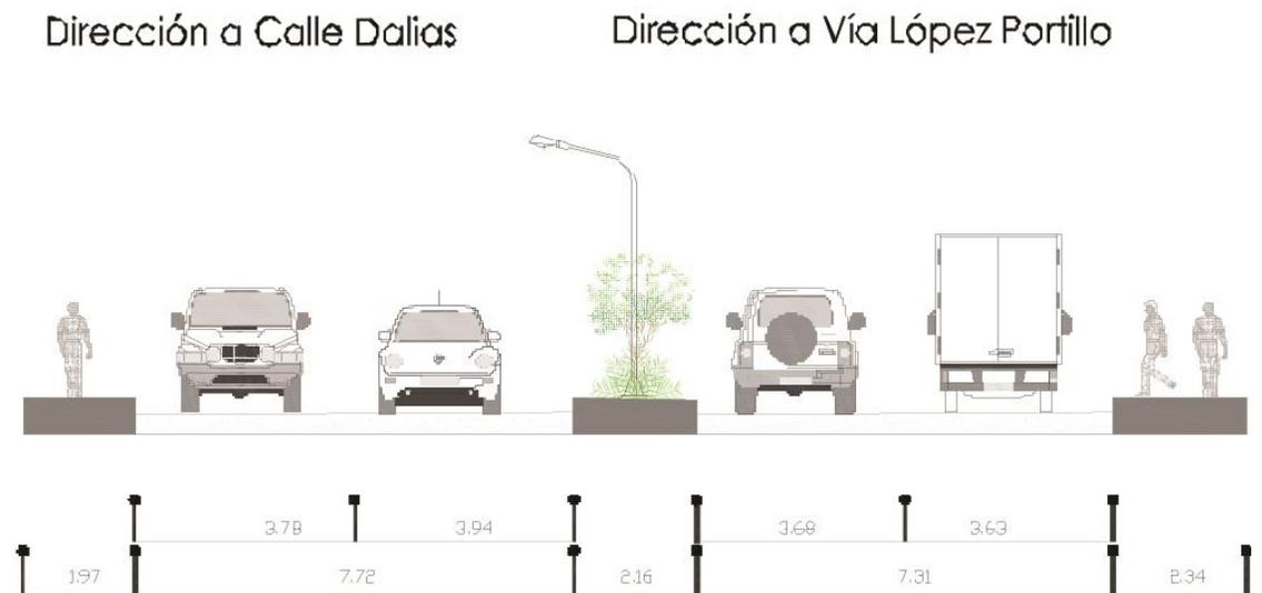
Figura 80. Sección transversal del corredor vial De las Flores.
