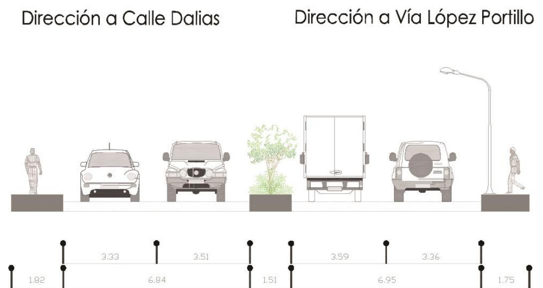
Figura 76. Sección transversal del corredor vial Zarparrilla.
