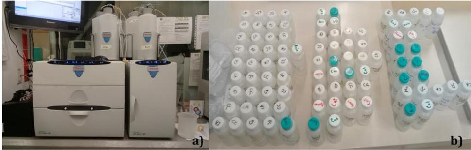
Figura 2.5. a) Cromatógrafo iónico Dionex ICS-5000+DP. b) Muestras de agua en frascos de 70 mL para análisis de aniones y cationes.
