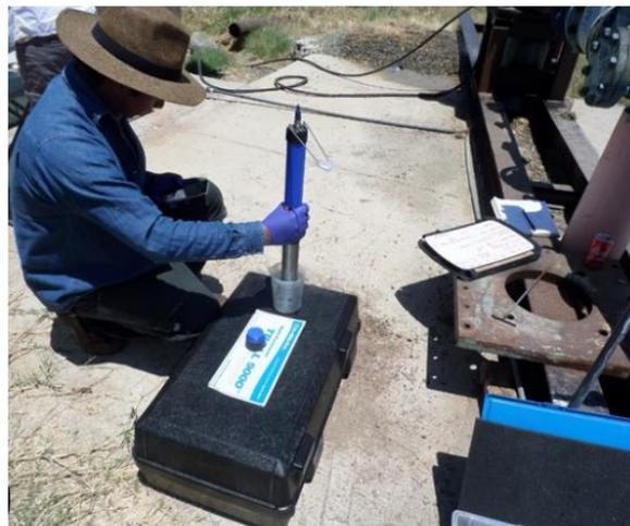
Figura 2.2. Los datos físico-químicos se obtuvieron a través del uso de la sonda Aqua TROLL 600 Vented.
