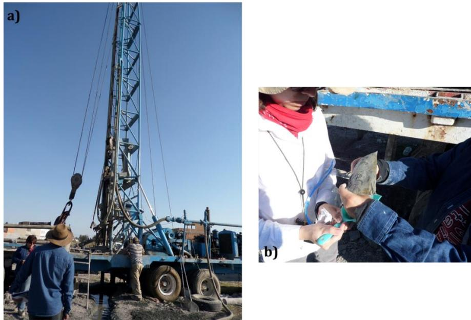
Figura 2.1. a) y b) Colecta de muestra de esquilas de una perforación de pozo en Ocotlán, Jalisco.
