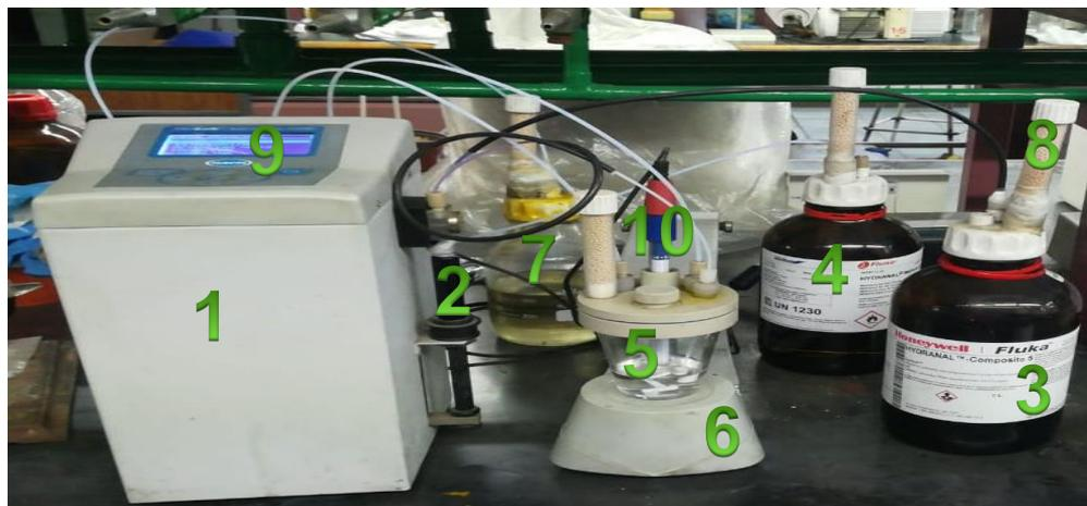
Figura A.1 Componentes del equipo de titulación Karl Fisher
