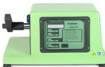
Figura C.1 Máquina de pruebas de resistencia (*Simpson Core Tensile Strenght tester*)
