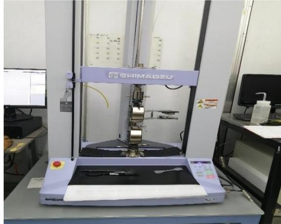
**Figura 4.5-5** Máquina de ensayos de resistencia a la tensión
