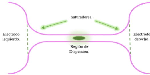
Fig.2.1. Estructura de una unión cuántica o nanoconexión.
