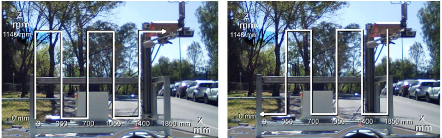
Figura 5.4F. Trayectoria realizada por el sistema PACS incorporado en el remolque SWAP, que se coloca de manera perpendicular al flujo vehicular en dirección Y, mientras el brazo se desplaza sobre el plano X, Z.
