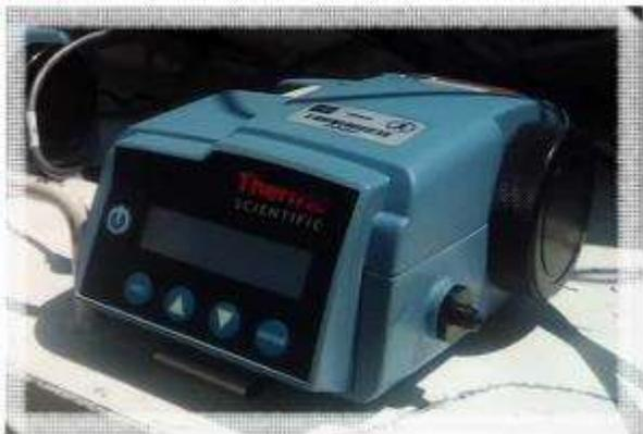
Figura 5.2B Medidor portátil de PM<sub>2.5</sub> Thermo PDR-1500
