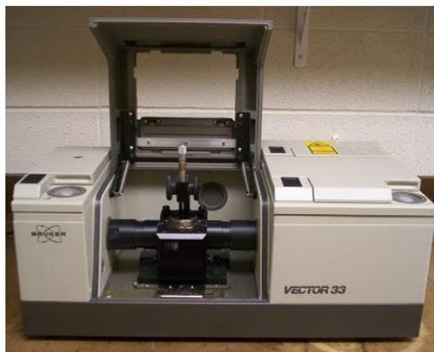
figura 3.10 Espectrómetro de infrarrojo con transformada de Fourier marca Bruker Vector 33.
