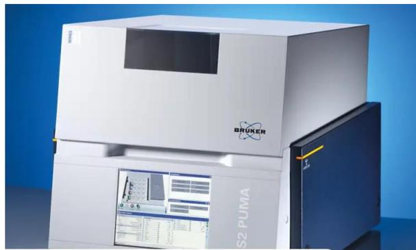
figura 3.9 Espectrómetro de Fluorescencia de Rayos X marca Bruker modelo S2PUMA.
