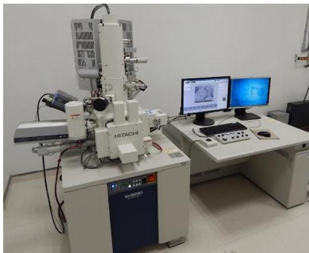
*figura 3.5 Microscopio electrónico de barrido de emisión de campo de cátodo frío Hitachi SU8230.*
