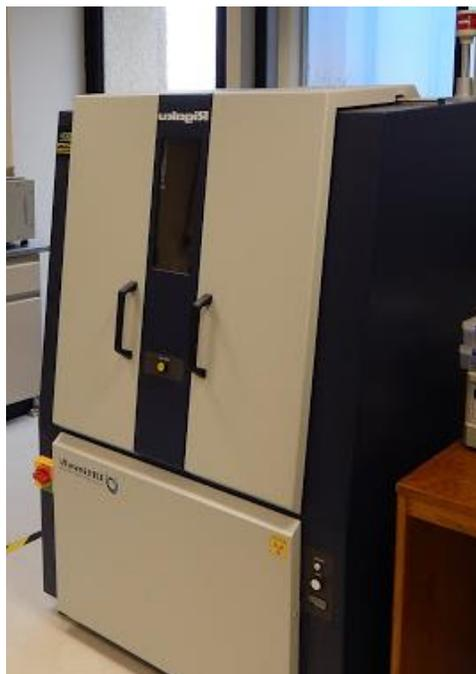
figura 3.7 Difractómetro Rigaku, modelo Ultima IV.
