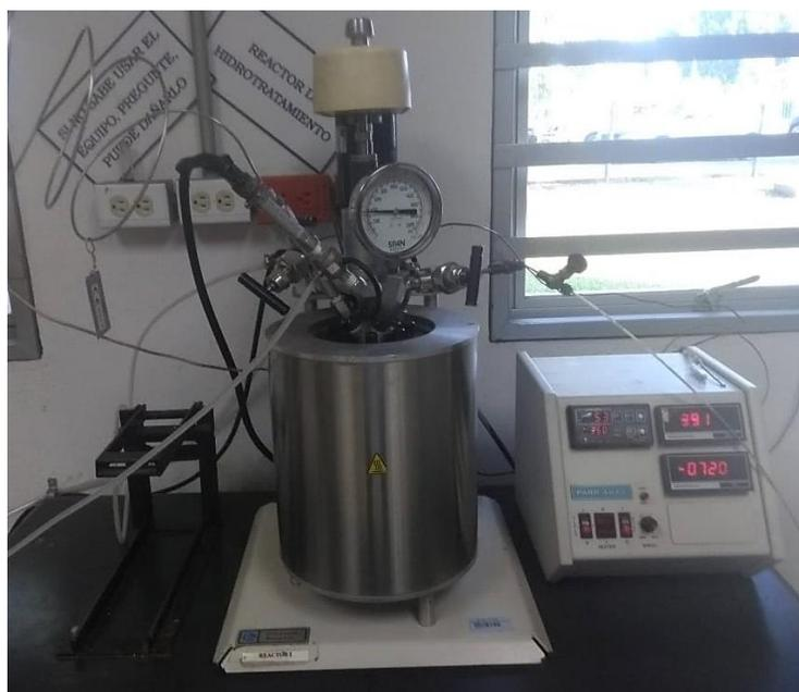
figura 3.11 Reactor tipo Batch modelo Parr 4522.
