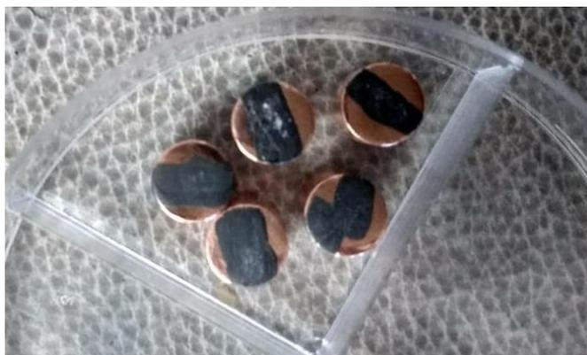
*figura 3.6 Catalizadores depositados sobre barriles de cobre usando tinta conductora de grafito.*
