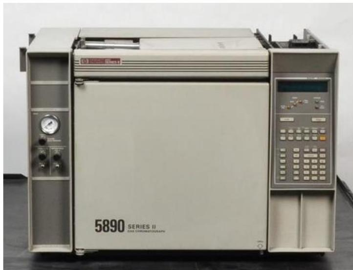
*figura 3.12 Cromatógrafo de gases modelo HP 4890.*
