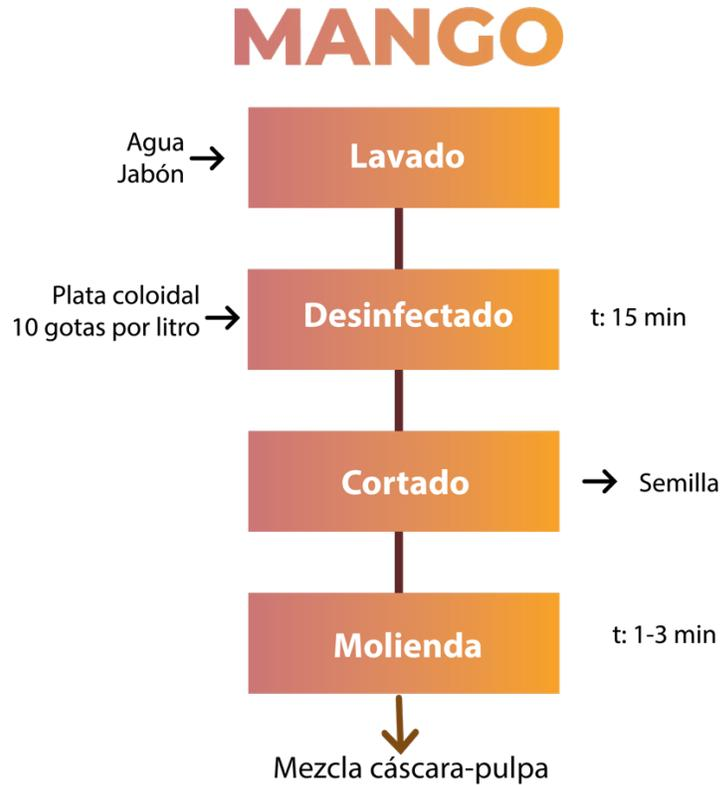
**Figura 18.** Diagrama de procesos para la mezcla de mango integral
