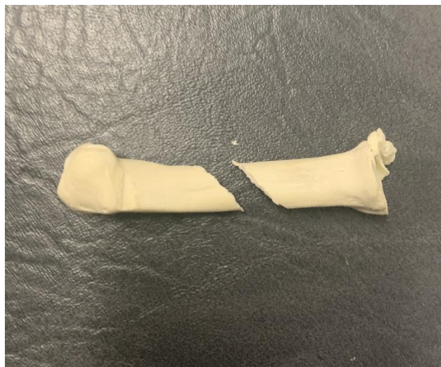
Imagen 3. Metacarpiano con trazo de fractura simple oblicuo largo de 40° en la diáfisis
