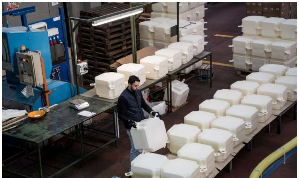
Foto 56. Fabricación de módulos de polietileno de alta densidad para proyecto "The Floating Piers" Fuente: Christo and Jeanne Claude
