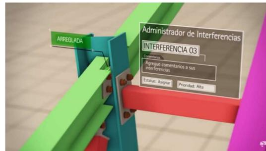
Figura 4.17 – Corrección de la interferencia, mediante el modelado a detalle de la intersección entre la viga y la columna [Tekla Software, 2016].
