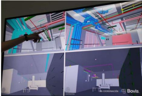
Figura 2.13 – Revisión de interferencias del sistema estructural con las tuberías, [Cervantes L. Areli, 2017].
