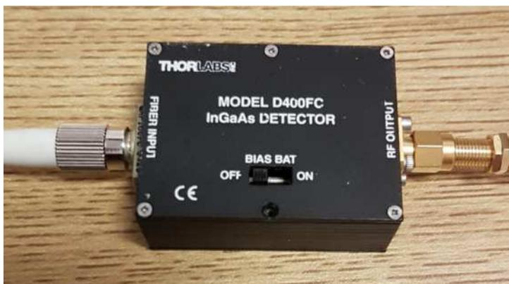
Figura C.9: Fotodetector de fibra óptica InGaAs D400FC de Thorlabs.
