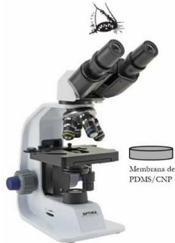
Figura 2.4: Esquema representativo de la medición de los espesores de las membranas usando el microscopio.
