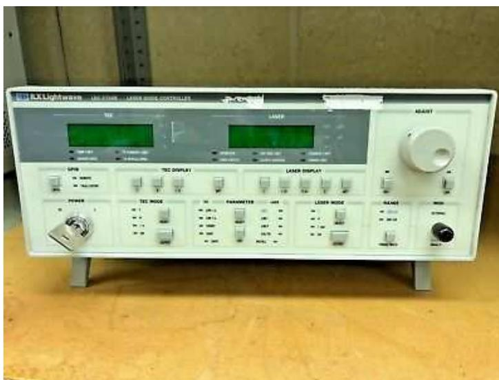
Figura C.3: Controlador de diodo láser LDC-3724B.
