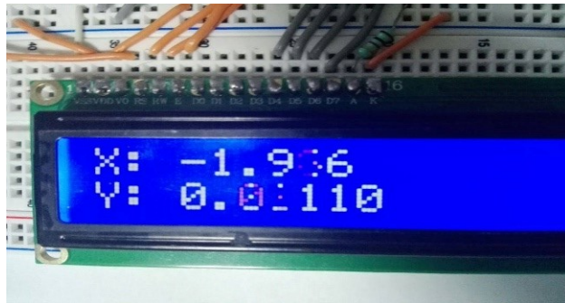
Figura 3.17: Lectura del ADC en pantalla LCD.
