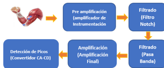
Figura 2.6: Proceso de acondicionamiento de las señales mioeléctricas.
