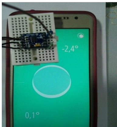
Figura 3.16: Medición de valores del sensor.
