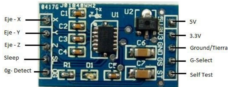
Figura 2.7: Pines de conexión Acelerómetro MMA7361 [6].
