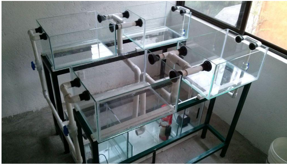
Figura 7. Ensamble del sistema experimental y prueba de fugas.
