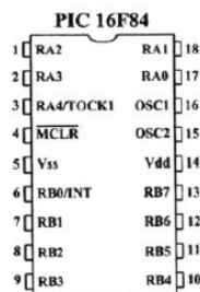
Figura 4.7: Distribución de los pines del microcontrolador PIC16F84A[3].
