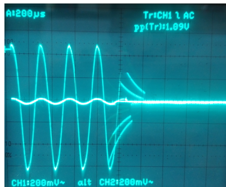
Figura 6.6: Comparación de las señales de entrada y salida del amplificador.
