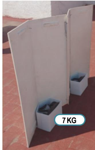
Pruebas de esfuerzo en un modelo escala 1:3 en el que prueba se aplicó una fuerza considerable, los soportes se colocaron únicamente de un lado, podemos notar que el elemento que sostiene a los paneles no fue lo suficientemente resistente.
