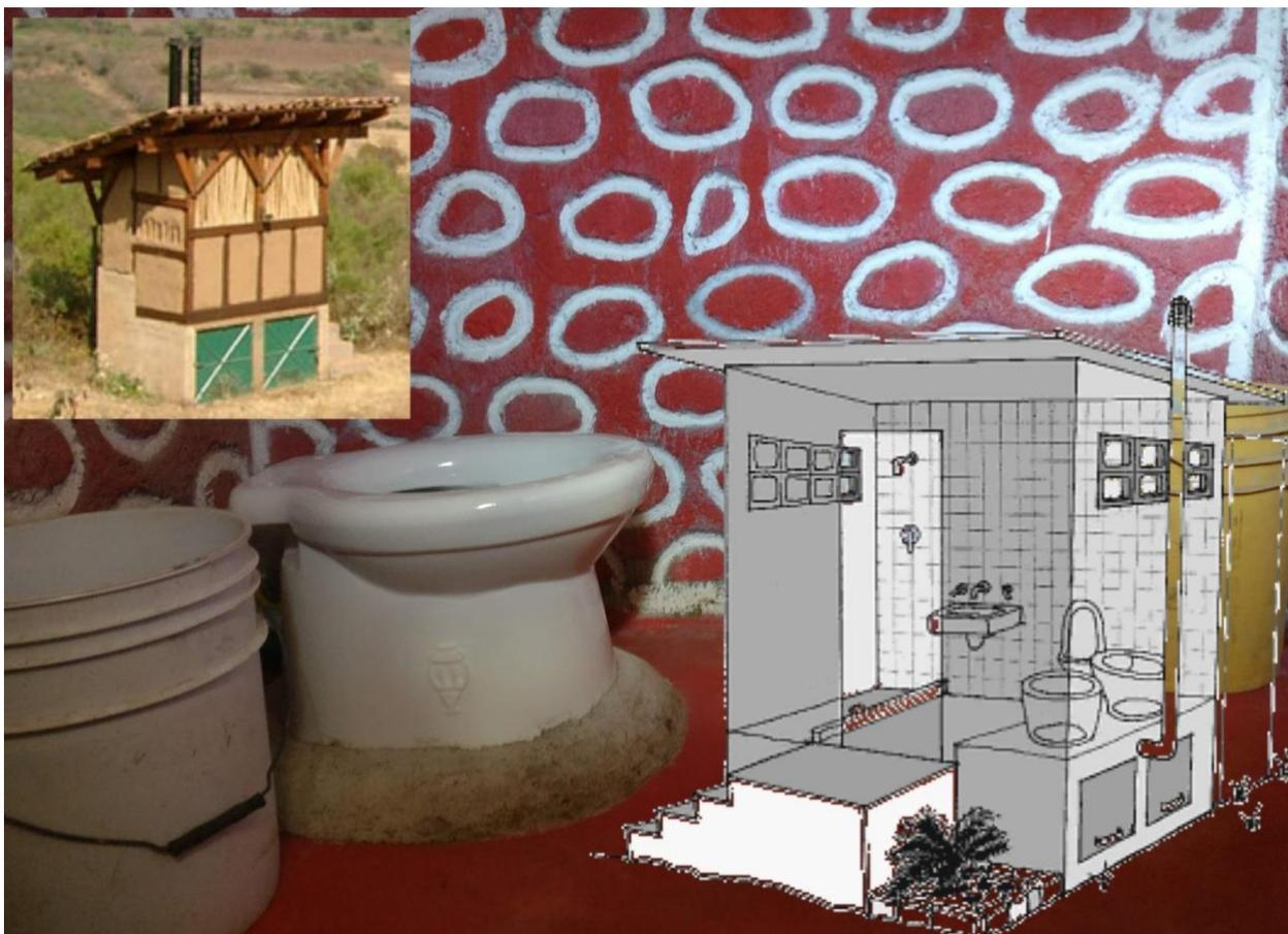
*Figura 7. Ejemplos de baño seco con cámara de recolección.*
