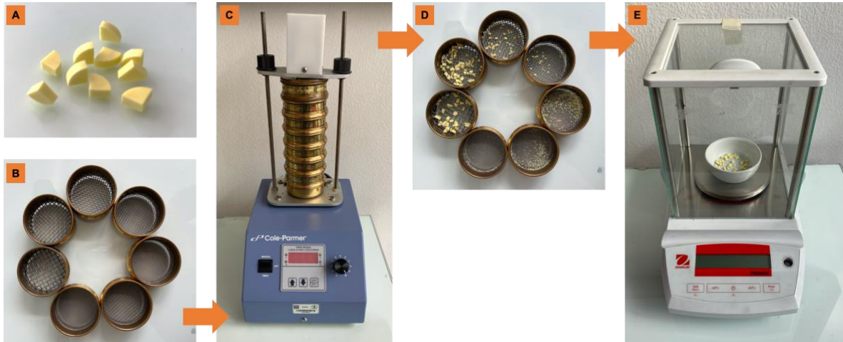
Figura 8. Flujo de procesamiento del material masticado. (A. Cuartos de tabletas de alimento prueba artificial; B. Torre de 7 tamices con aperturas cuadradas con rango de 5.6 a 0.25 mm usado para tamizar las tabletas masticadas; C. Torre en tamizador colocado 150 segundos para que las partículas de las tabletas masticadas sean separadas por el mecanismo y vibración del aparato; D. Cantidad del material en cada tamiz después del uso del tamizador; E. Obtención de peso de cada tamiz con uso de balanza analítica.)
