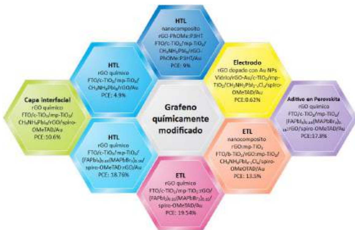
Fig. 1.4 Resumen de compuestos a base de grafeno utilizados en capas de PSCs [63]
