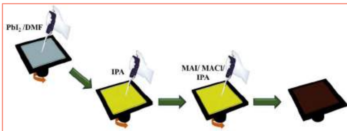
Fig. 5.2 Esquema de deposición de \text{PbI}_2 y perovskita por 2-pasos [26]
