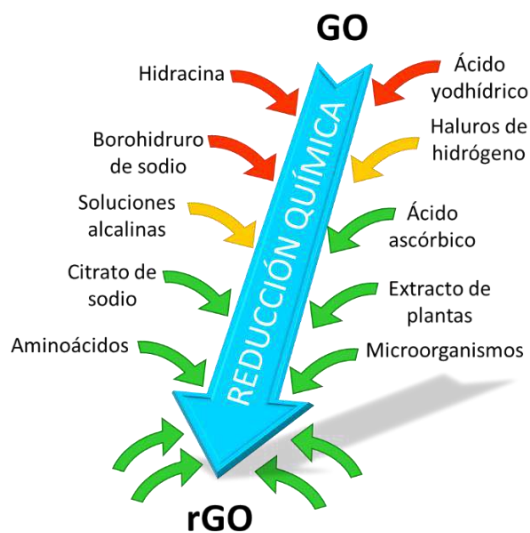
Fig. 1.3 Representación esquemática de los principales reductores químicos usados para la reducción química del GO
