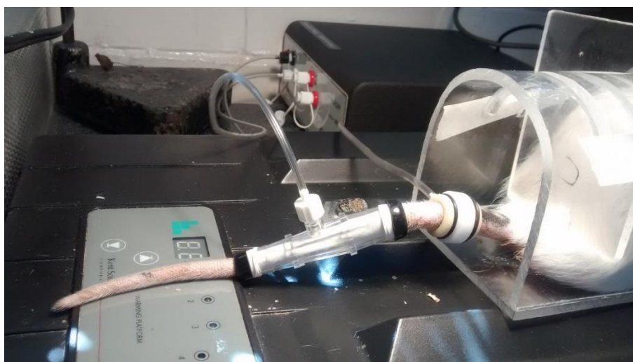
Figura 3. Medición de presión arterial por medio del equipo CODA, que es un sistema de alto rendimiento para medir la presión arterial en ratas.
