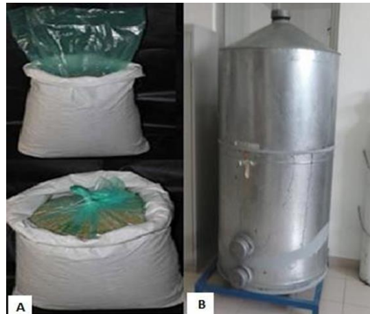
Figura24. a) Almacenamiento de granos en sacos de plástico multilaminado, se extrae el aire dentro del saco y se asegura su hermetismo mediante el amarrado de la bolsa; b) Silo hermético de metal (Imágenes de Grain Pro Inc., y del laboratorio de UNIGRAS, FES-Cuautitlán)
