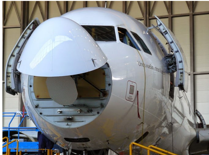
Figura 1.12: Radomo utilizado en un avión para proteger un radar meteorológico [21].
