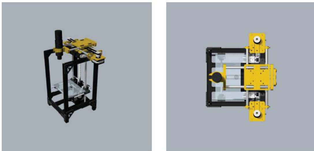
Figura 3.35: Planos CAD 3D del sistema de microscopía. En la figura de la derecha se muestra el sistema x-y para desplazar el objetivo a lo largo de la placa.
