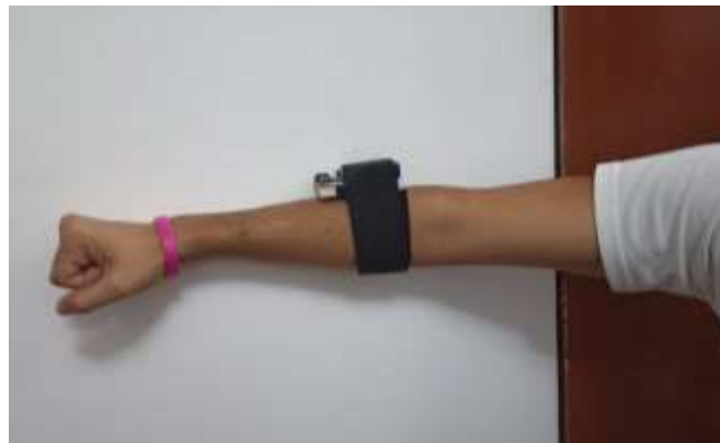
Figura 36.- Imagen de uso del sistema para validación de giroscopios con rotaciones de hombro.
