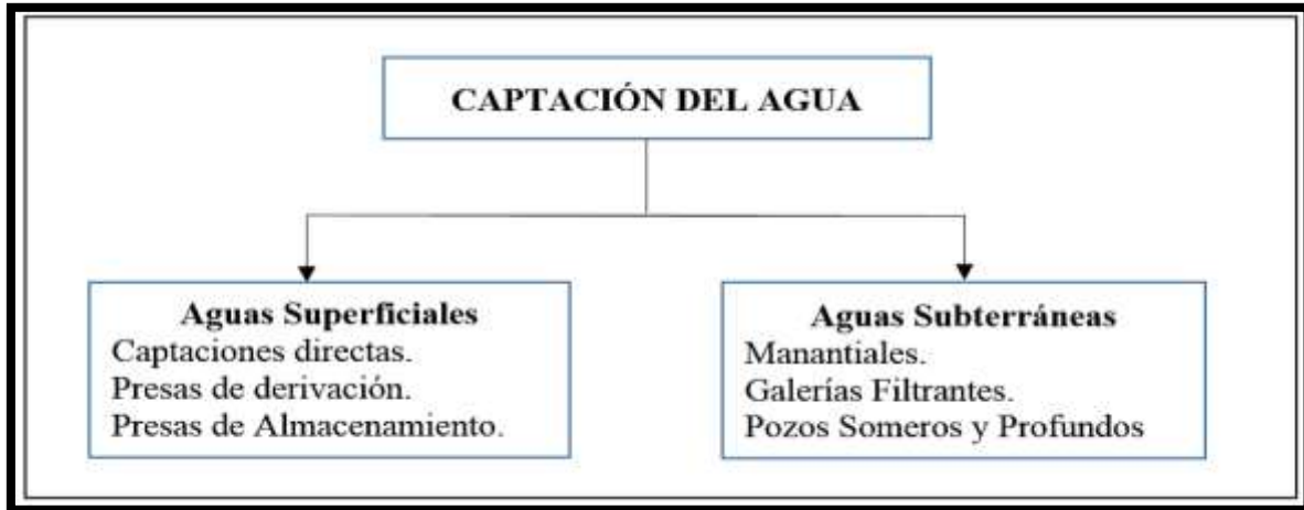
Figura 1. Fuentes de captación del agua.
