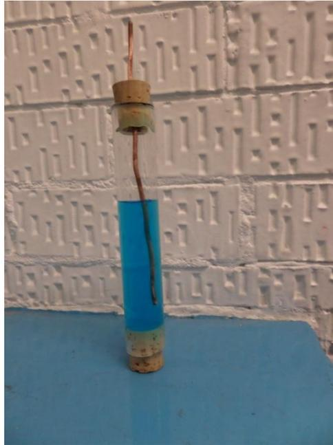
Figura 3.4. Electrodo de referencia Cobre-Sulfato de Cobre (Cu/CuSO<sub>4</sub>)
