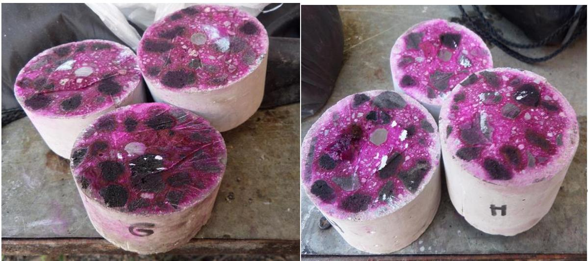
(NO<sub>x</sub>), hacía el interior del concreto no ha producido ningún daño en la varilla (acero de refuerzo).
