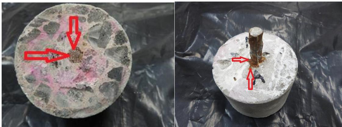
**Figura 4.6. Secciones de la probeta “A”, las flechas muestran los productos de la corrosión (herrumbre) formada en el acero de refuerzo a consecuencia del ataque del ion cloruro.**
