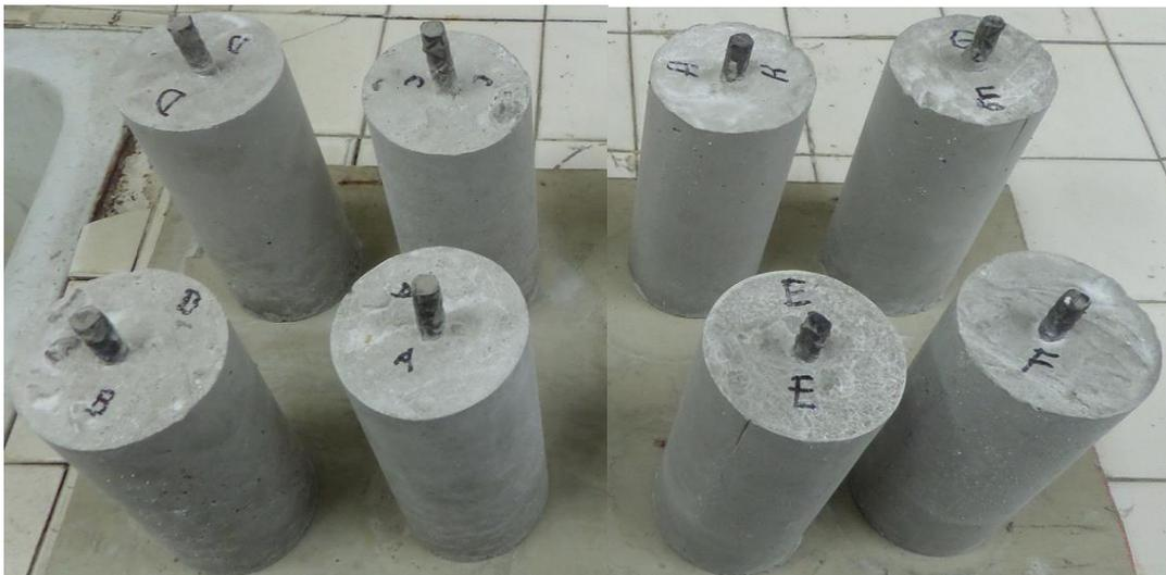
**Figura 4.10. Probetas antes de ser sometidas a ensayos de corrosión acelerada, sin gases y en solución salina (A y E), con gases y solución salina (B y F) y solo gases (C,D,G y H)**
