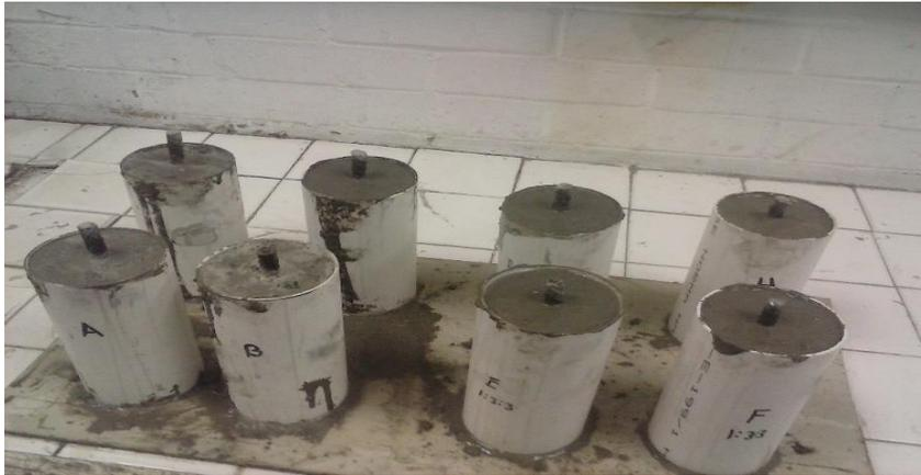
**Figura 3.2. Probetas después de ser coladas.**
