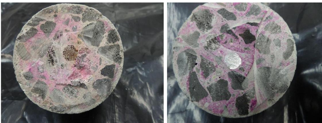
**Figura 4.5. Cambio de coloración en las secciones de las probetas (izquierda “A” y derecha “E”) sumergidas en solución salina al 3.5%**
