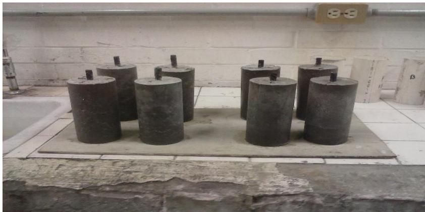
**Figura 3.3. Probetas después de ser desmoldadas. Las cuatro del lado izquierdo tienen una relación a/c de 0.59, las cuatro de la derecha tienen una relación a/c de 0.63.**
