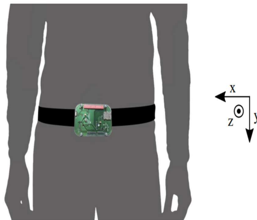
Figura 3.3: Dispositivo utilizado para la adquisición. El dispositivo integrado de desarrollo propio incluía dos acelerómetros y un giroscopio. Se fijó a la cintura de los participantes [36]
