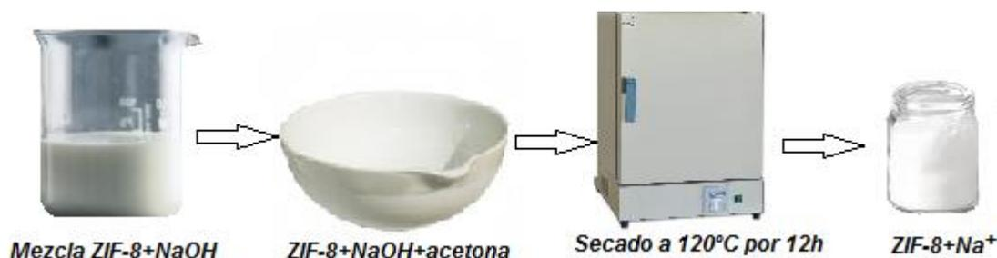
Figura 8. Lavado y secado de ZIF-8+Na<sup>+</sup>.
