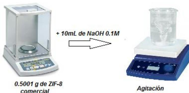
Figura 7. Esquema de impregnación con cationes Na<sup>+</sup> de la ZIF-8 comercial.
