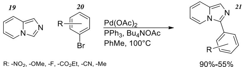
**Esquema 2.** Acoplamiento de Heck en imidazo[1,5-a]piridina.
