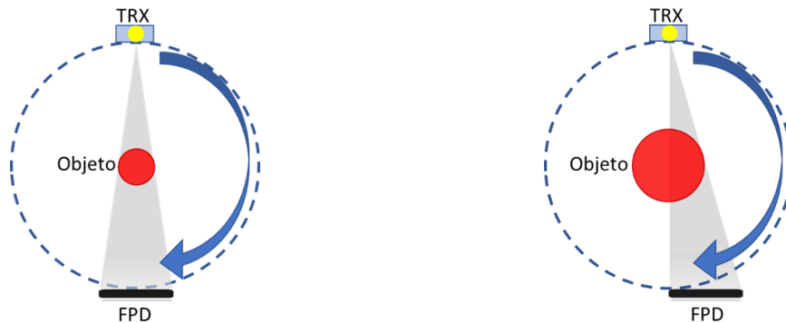
Figura 3.4 Geometría full-fan usada para escaneos de objetos pequeño (ej. Protocolos de cabeza y cuello) y geometría half-fan usada para escaneos de objetos de mayor tamaño (ej. Protocolos de pelvis).
