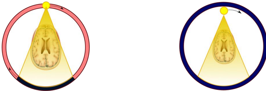
Figura 2.11 CT de tercera generación en el cual se usó un haz de abanico que cubre la muestra totalmente para solo girar alrededor de una órbita adquiriendo las proyecciones (izquierda). CT de cuarta generación en el cual se tiene una órbita completa de detectores para reducir el movimiento mecánico de estos y así solo rotar el tubo de rayos X (derecha).
