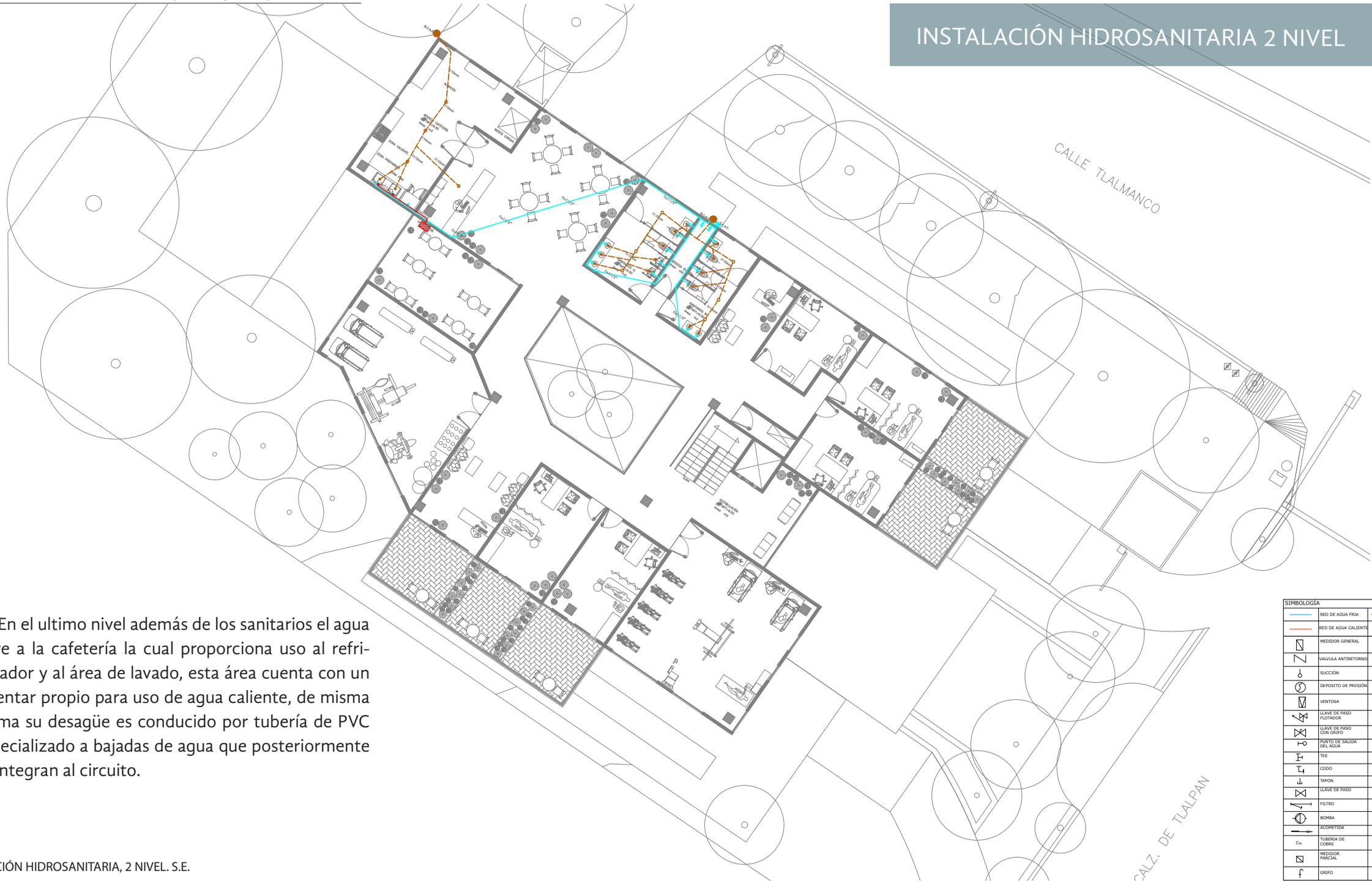
En el ultimo nivel además de los sanitarios el agua sirve a la cafetería la cual proporciona uso al refrigerador y al área de lavado, esta área cuenta con un calentador propio para uso de agua caliente, de misma forma su desagüe es conducido por tubería de PVC especializado a bajadas de agua que posteriormente se integran al circuito.
