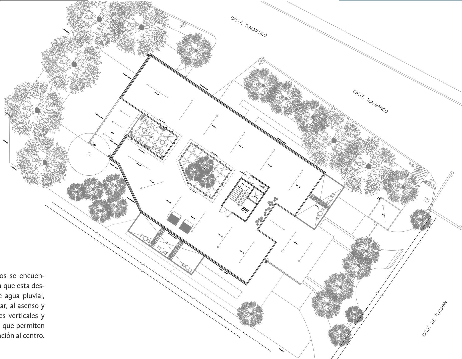
En la planta de techos se encuentran pocas actividades ya que esta destinada a la captación de agua pluvial, captación de energía solar, al asenso y descenso de circulaciones verticales y las techumbres de vidrio que permiten la entrada de sol y ventilación al centro.
