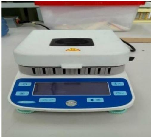
*Figura 23. Termobalanza utilizada para curva de remojo.*
