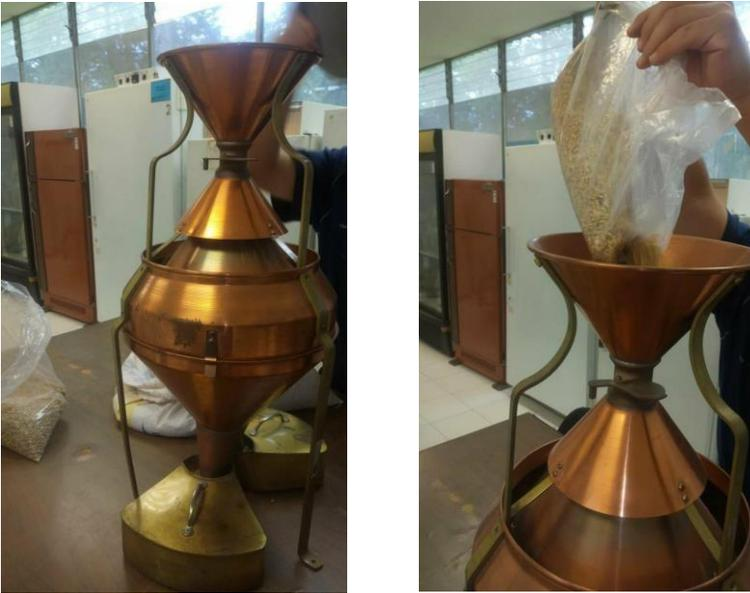
*Figura 20. Homogeneizador borner, utilizado en muestreo.*
