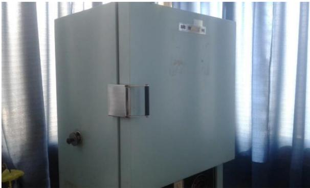
*Figura 37: Estufa de secado BLUE M*
