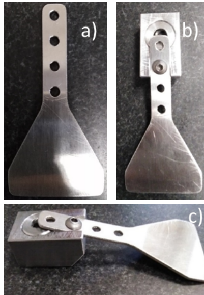
Figura 4.14: Componente total de ensamble: a) Placa de sujeción, b) componente total vista superior c) vista lateral.
