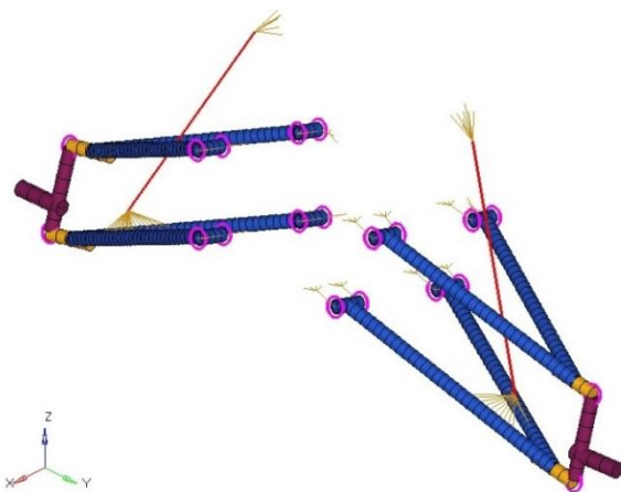
Figura 3.20 Modelado de la suspensión delantera. Visualización detallada.
