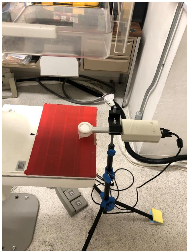
Figura 47. Colocación de la CI para medir CHR
