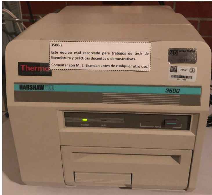
Figura 41. Equipo lector de dosímetros TL marca Harshaw modelo 3500
