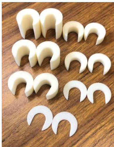
Figura 30 Espaciadores para maniquí que generan un gap de aire entre las capas de PMMA que conforman al maniquí para obtener técnicas
