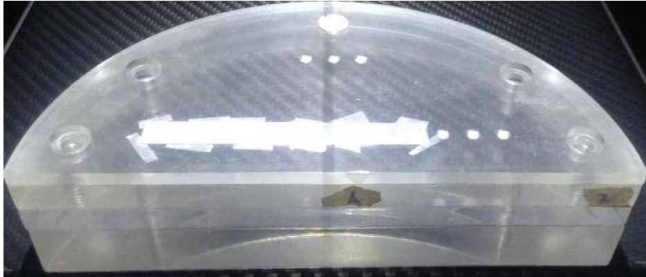
Figura 24. Maniquí dosimétrico con el conjunto de cuñas de aluminio de diferentes espesores para estimar la CHR, modificado de [10].
