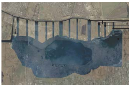
4.10 Plano de excavación de zanjas propuesto en el Plan Maestro Cuauhtli Fuente: Elaboración propia
