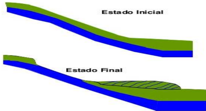
Figura 1.4. Diagrama de un deslizamiento causado por licuación de suelos en una pendiente pronunciada. La pérdida de resistencia ocasiona inestabilidad y el deslizamiento por la ladera.
