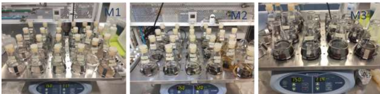
FIGURA 3.7 PRUEBAS EN LOTE PARA CADA UNO DE LOS MEDIOS UTILIZADOS
