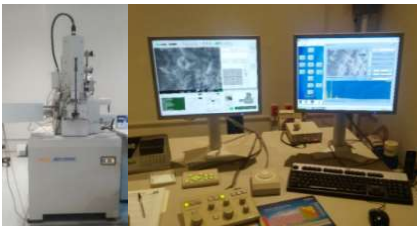
FIGURA 3.2 FE SEM JEOLJSM-7600F
