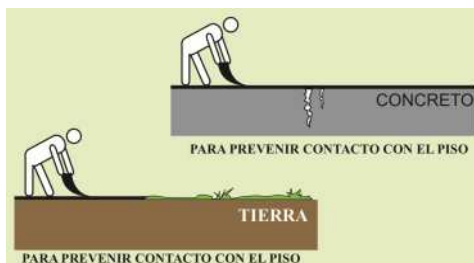
Imagen C. 69. Implementación de geomembrana para suelos al descubierto o pisos con revestimiento fracturado.
